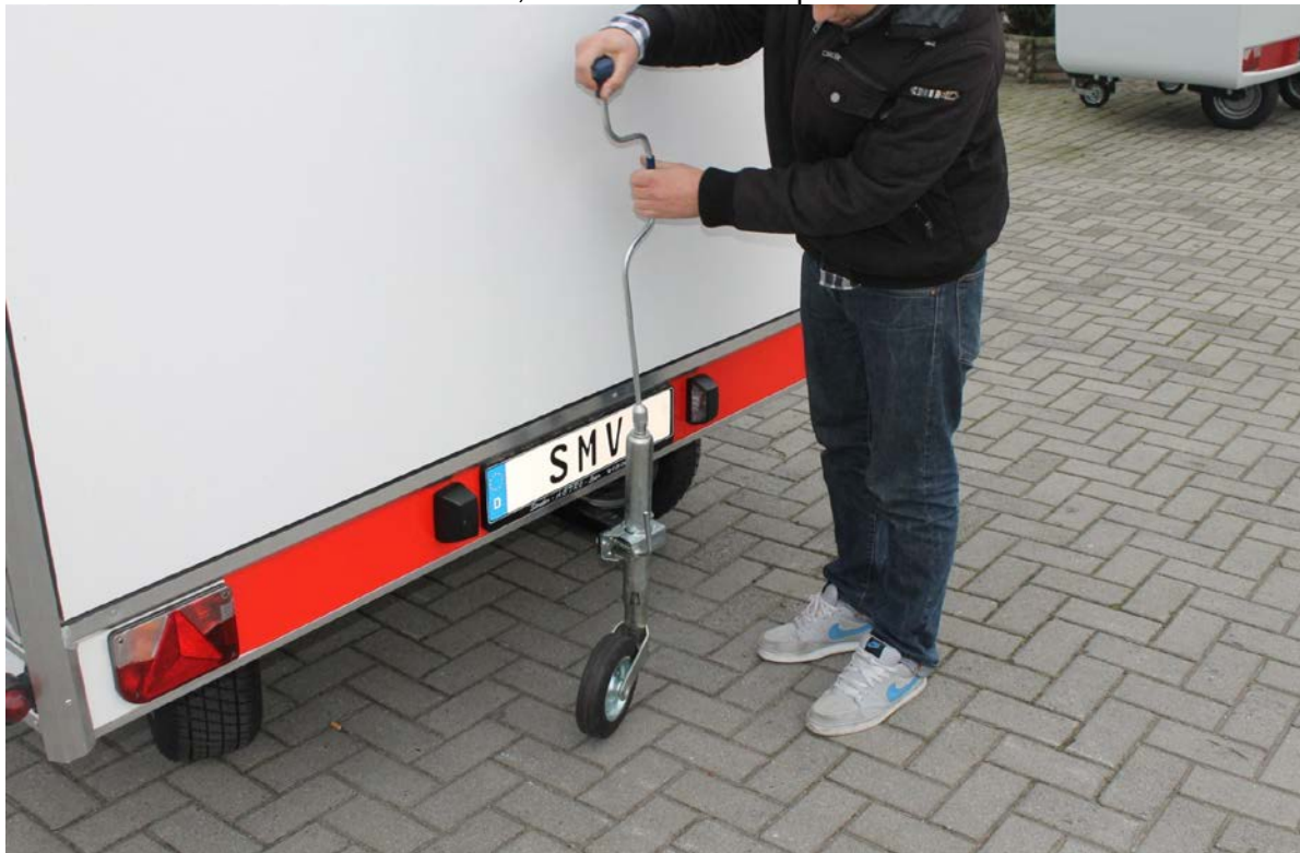
3.1.4 Hinteres Stützrad hochkurbeln, so dass sich der Space Extender vorne anhebt
