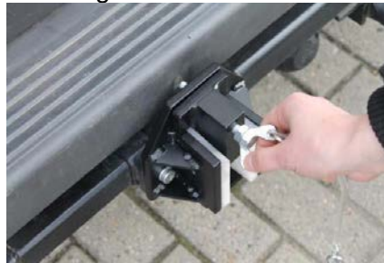
3.1.4 Hinteres Stützrad hochkurbeln, so dass sich der Space Extender vorne anhebt
