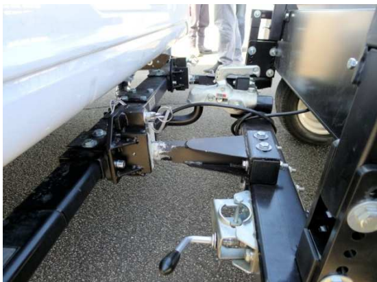
Zugkugelnkupplung mit Führungs- fingern am Space Extender, an das Wohnmobil gekuppelt
