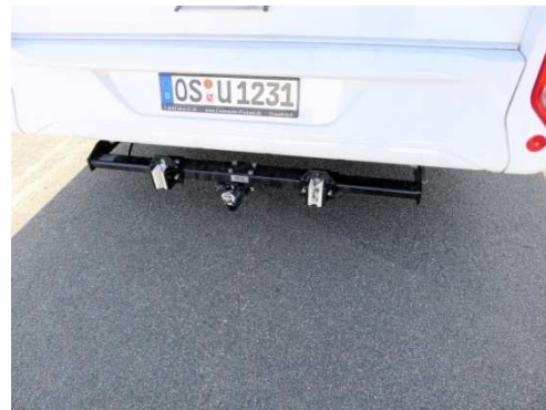
Kupplungskugel mit Halterung mit Führungs- nasen am Wohnmobil
