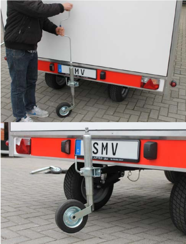
3.3.1 Stützrad hinten hochkurbeln, so dass ausreichende Distanz für das Abkuppeln entsteht.
