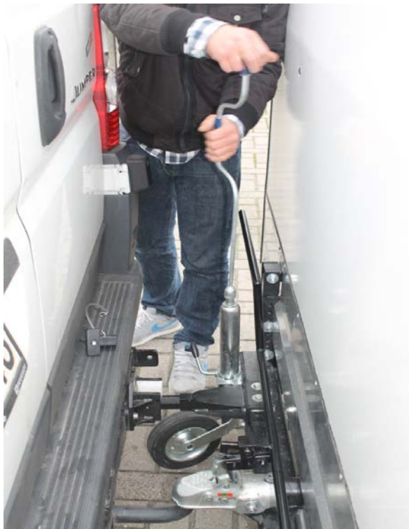
3.3.2 Beide Stützräder vorne herunterkurbeln um Druck auf die Zugkugelkupplung aufzubauen.
